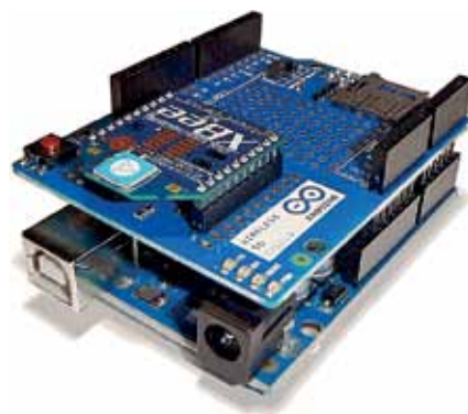
Рис.14. Плата расширения Arduino Wireless Shield, установленная на модуль Arduino Uno. На нее, в свою очередь, установлен модуль Xbee
