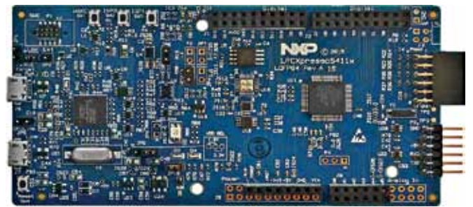
Рис.11. Оценочная плата LPCXpresso компании NXP
